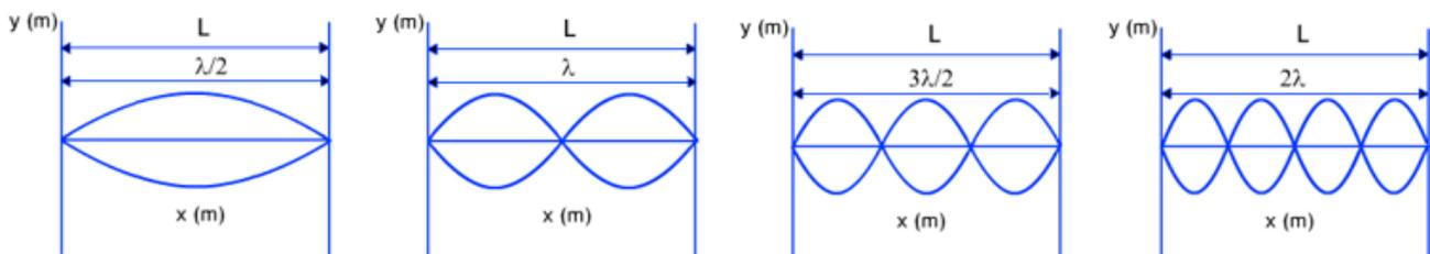
Como se ve para una cuerda con los extremos fijos todos los armónicos han de cumplir la condición de contorno de que **en los extremos existan nodos**. Para el cuarto modo su longitud de onda es un cuarto de la del modo fundamental y, en consecuencia, su frecuencia será cuatro veces superior a la frecuencia fundamental.
