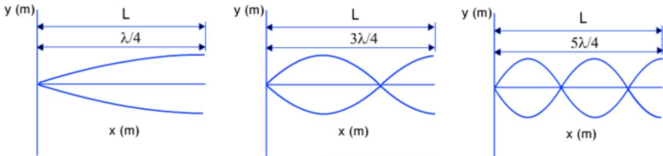
Condición para que se forme la onda:  $L = n \frac{\lambda}{4} ; \lambda = \frac{4}{n} L$
