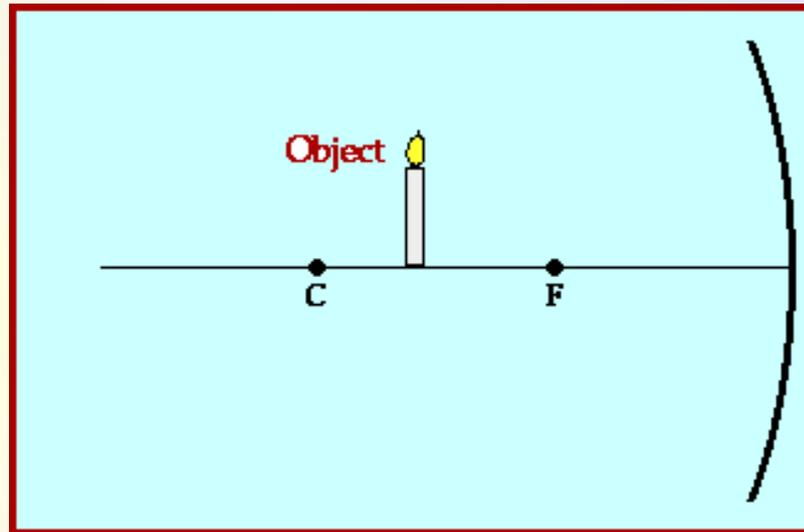
Si el objeto está situado entre el centro de curvatura y el foco, la imagen será mayor, real e invertida. Estará situada entre C y el infinito
