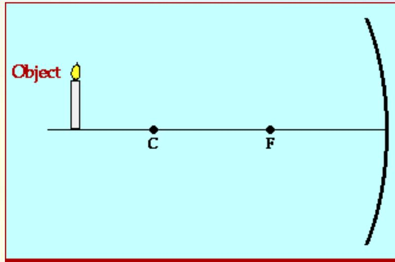
Si el objeto está situado entre el centro de curvatura y el infinito, la imagen será menor, real e invertida.
